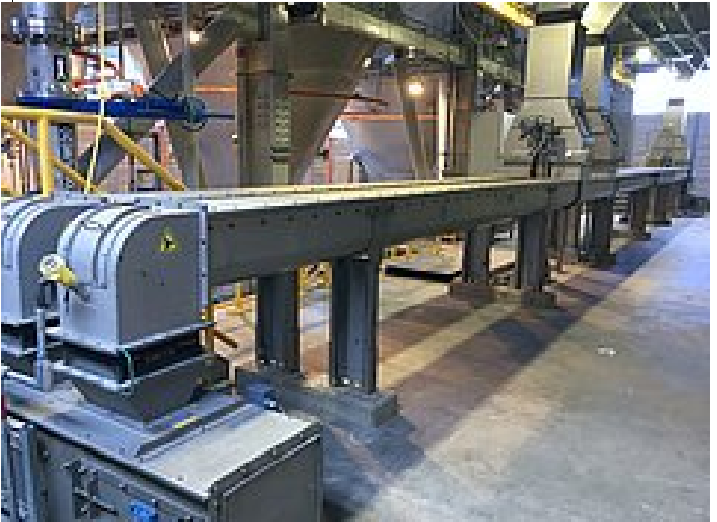
Vis sans fin pour boues sèches Ro8 T de la marque HUBER
