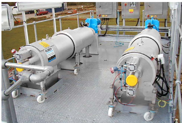
STRAINPRESS® avec tuyau chauffant.
