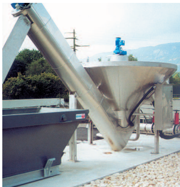
Une technique innovante : Laveur à sable RoSF4 taille 3, version calorifugée pour installation en extérieur.
