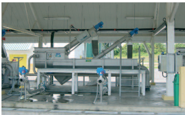
Unité de traitement des matières de vidange ROTAMAT® avec dessableur non-aéré et vis de classification intégrée
