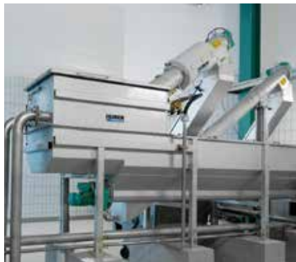
Usine d'acceptation de matières de vidanges HUBER ROTAMAT® Ro3.3, éprouvée dans des centaines d'installations dans le monde entier.
