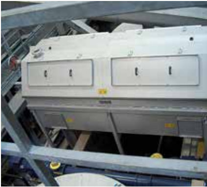
Tamis à tambour HUBER RoMesh® pour l'élimination des matières fines et fines.
