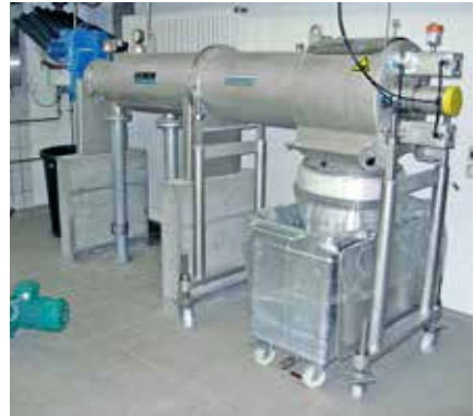
Nettoyeur de boue HUBER STRAINPRESS® - séparation continue sous pression des matières grossières la séparation.
