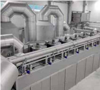
Séchage des boues dans l'industrie avec le sécheur à bande BT HUBER.
