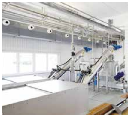
Tamis rotatif HUBER ROTAMAT® Ro2 avec crépine jusqu'à 3 m de diamètre.
