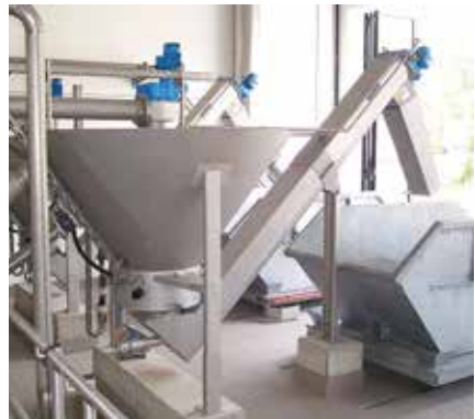
Technologie innovante : Classificateur-laveur de sables Coanda HUBER RoSF4
