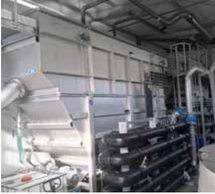
Installation de flottation à air dissous HUBER HDF pour la réduction des graisses et des solides avant le rejet indirect.
