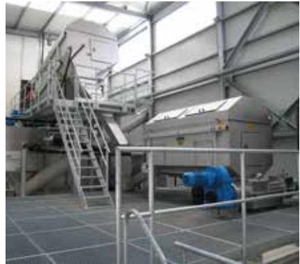
Système complet de traitement des graviers d'égouts et des déchets routiers.
