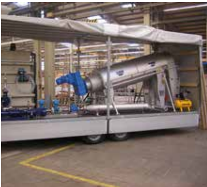
Presse à vis HUBER Q-PRESS® - unité mobile pour les essais sur site.
