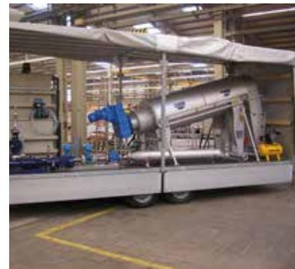
Prensa de tornillo HUBER Q-PRESS®: unidad móvil para pruebas in situ.
