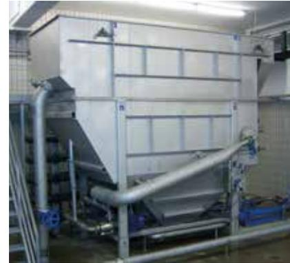
Planta de flotación por aire disuelto HDF HUBER para la separación de sólidos en una industria de bebidas.
