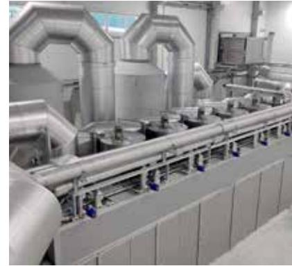
*Secado de lodos en la industria con el secador de cinta HUBER BT.*
