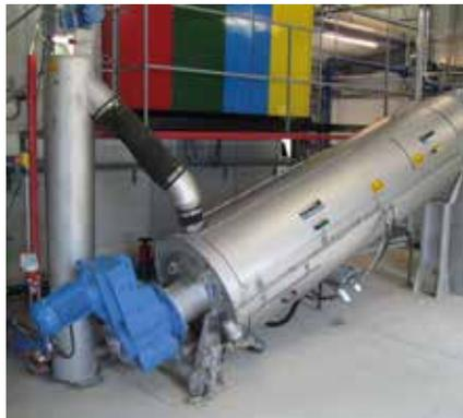
Prensa de tornillo HUBER S-PRESS: consumo de energía específico < 0,01 kWh/kg<sub>DR</sub>.
