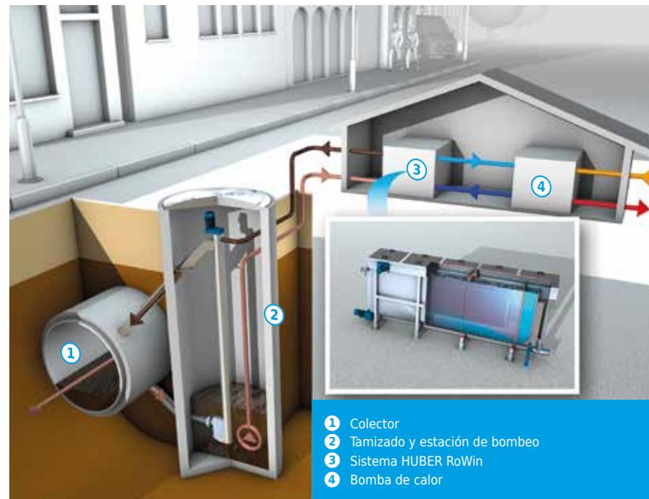
Diagrama esquemático de recuperación de calor de aguas residuales mediante un sistema HUBER ThermWin instalado en superficie.
