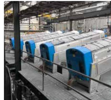
*Deshidratación de lodos con la prensa de tornillo HUBER Q-PRESS® 800.2.*
