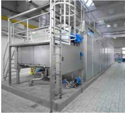
Secador de cinta HUBER BT para lodos residuales secado hasta > 90% residuo seco.
