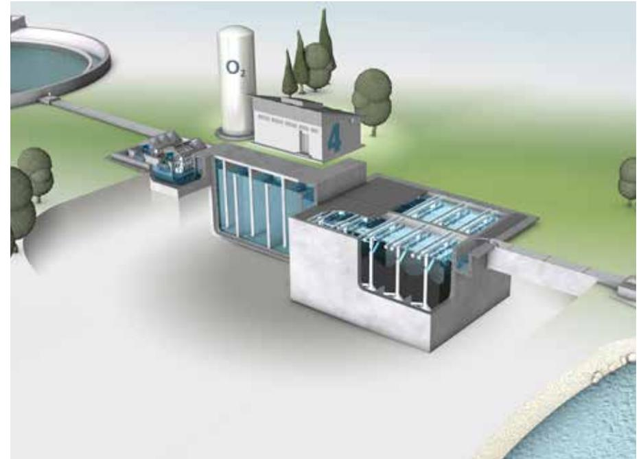
*Tratamiento avanzado de aguas residuales para la eliminación de trazas de sustancias con el proceso combinado de ozonización y el filtro de carbón activado CONTIFLOW® GAK posterior.*
