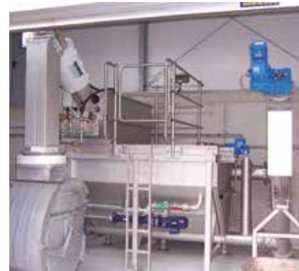
*Planta completa HUBER ROTAMAT® Ro5 HD con alimentador Hydro-Duct: la planta compacta de tratamiento de aguas residuales.*
