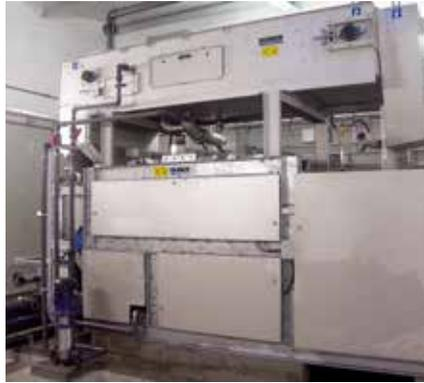
La prensa de filtro de banda HUBER B-PRESS puede combinarse con el espesador de cinta HUBER DrainBelt para aumentar aún más la capacidad.
