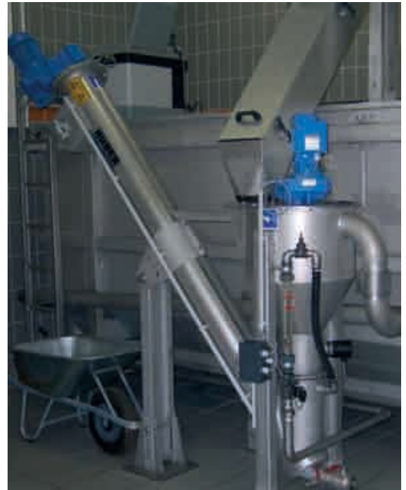
Laveur à sable sec COANDA/TC pour le lavage de petites quantités (100kg/h) de sables déjà classifiés (classificateur existant).
