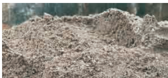
Sable de station d'épuration lavé
