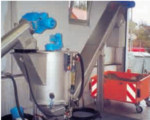
Laveur de sable sec COANDA/T pour le lavage de sables déjà classifiés.
