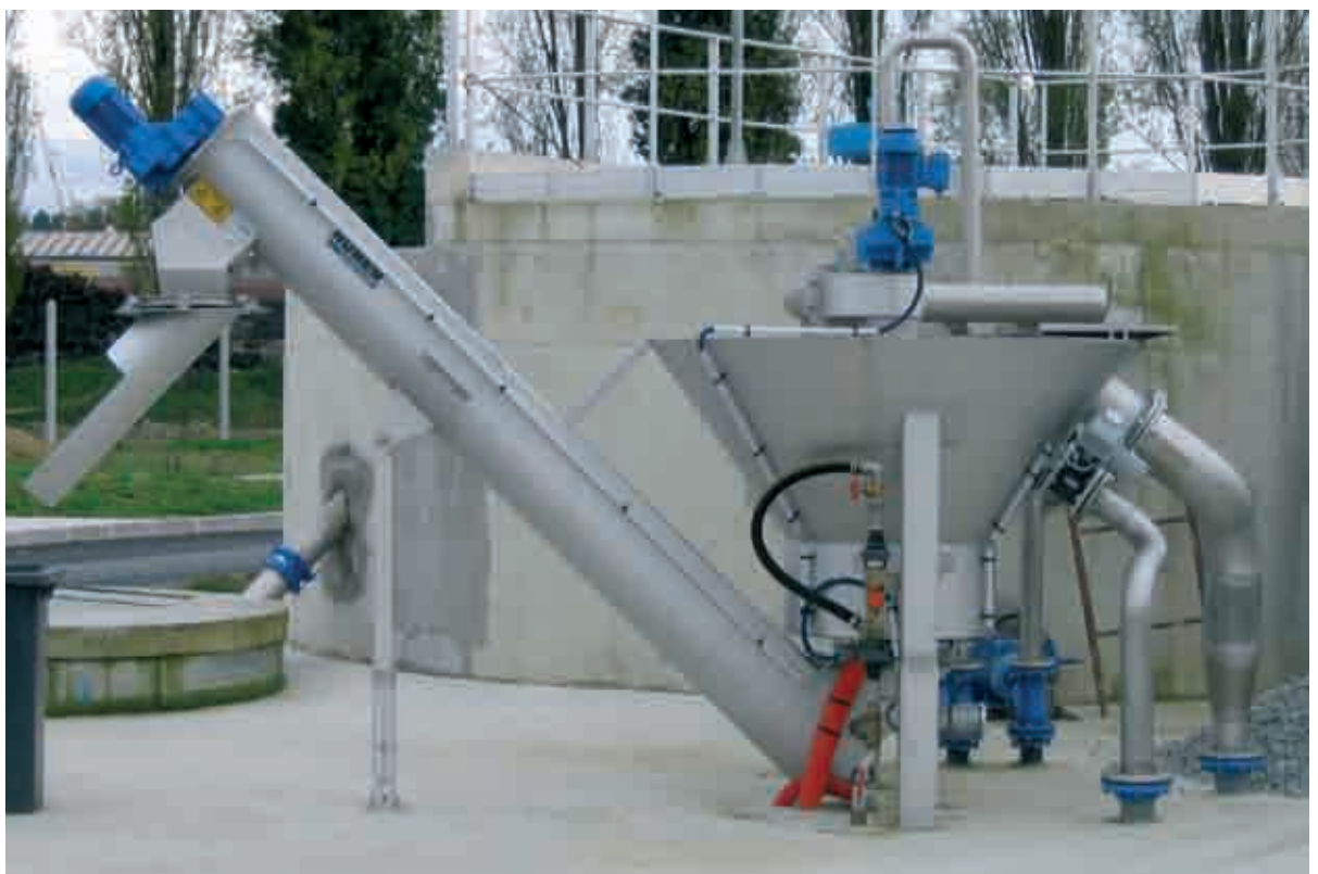
Laveur de sable COANDA taille 1, adapté pour des stations d'épuration de 10 000 à 50 000 EH
