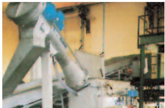
Tamis Ro 9 en caisson pour le tamisage des graisses et des boues
