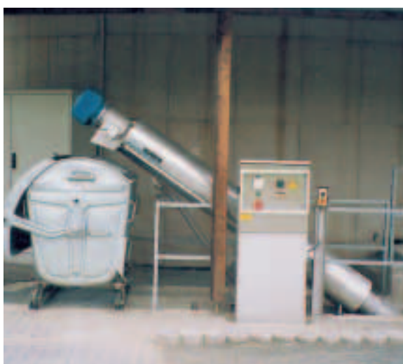
Unité ROTAMAT® Ro 9 dans sa version vis chauffante pour une installation en extérieur jusqu'à -15°C
